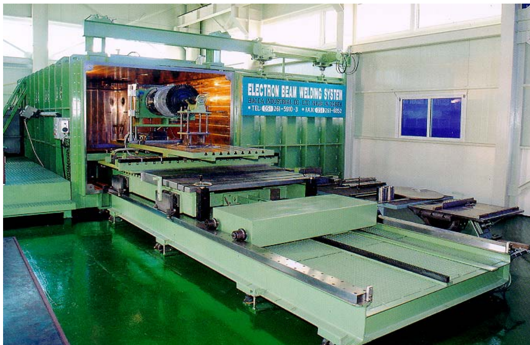
[전자빔 용접장치 전체 형태]
