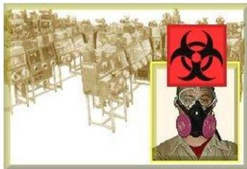
Bio-hazard Cabinet Class 는 최고 위험도의 생물재료를 취급하는 최고기밀이 유지된 캐비닛형으로 밀폐된 공간 내에서 부착된 고무 장갑 내에서 작업하기 때문에 Glove Box라고도 칭한다. 2개의 배기계통은 HEPA로 구성되어 있고, 한 곳의 계통이 고장나면 다른 계통으로 자동 운전되도록 완벽한 안전 구조를 가지고 있다.
